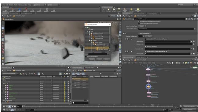
**04** **materiallibrary** ノードを選択し、**Number of Materials** の横にある + (プラス) 記号をクリックします。新しいリストの **Material VOP** の横にある **Operator Chooser** ボタンをクリックして、**fireball** オブジェクト、**lopnet\_fireball**、**matnet** と移動していき、**Pyro\_Shader** を選択します。**Accept** をクリックします。
