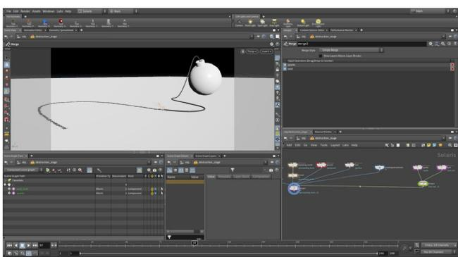
**04** ネットワークビューで **Tab > Reference** を選択し、クリックして **reference** ノードを追加します。**Reference File** の横にある **File Chooser** をクリックし、**sparks.usd** ファイルを指定します。ノードを **sparks** という名前に変更します。**Primitive Path** を **/fx/\$OS** に設定します。
